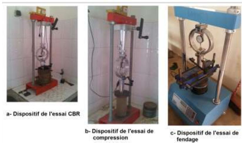
Figure 3 : Dispositif expérimental de détermination de propriétés mécaniques
