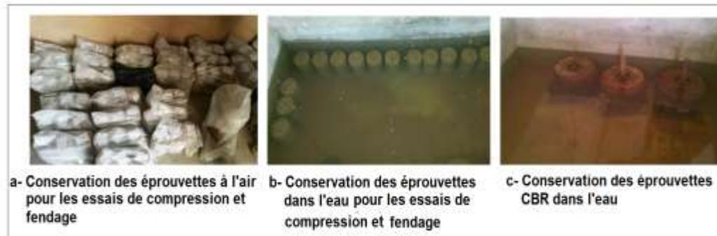
Figure 2 : Dispositif expérimental de préparation des éprouvettes
